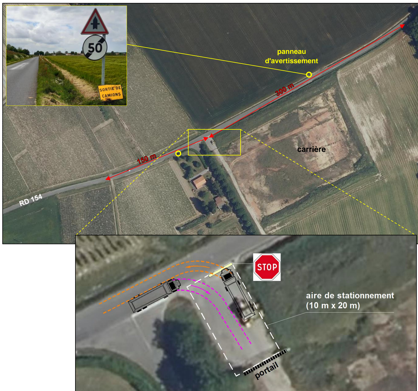
Figure 14 - Sécurisation routière au droit de l'accès au site
